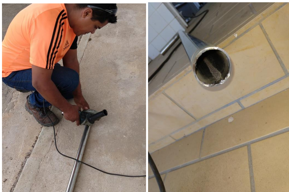
Figura 9 – Avaliação das tubulações de leite
